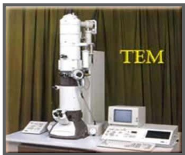
ภาพที่ 5 กล้องจุลทรรศน์อิเล็กตรอนชนิดส่อง ที่มา; http://www.khu.ac.th/partda55/un1typee.html
