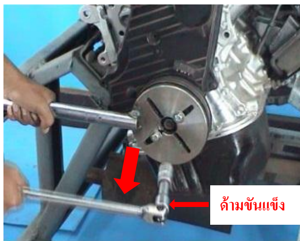
ภาพที่ 3.4 แสดงถอดด้ามขันแฉ่ง
