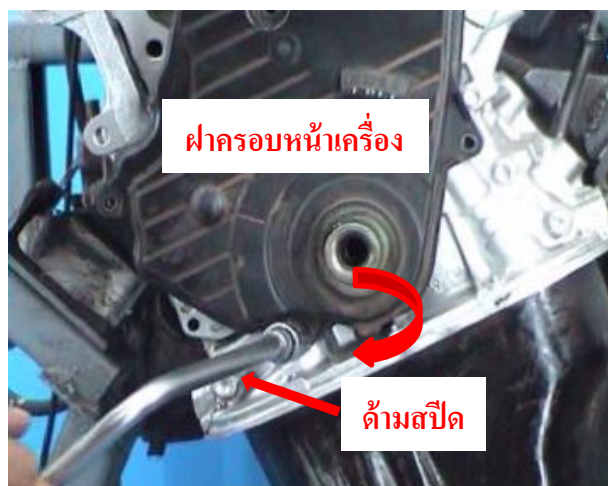
ภาพที่ 3.34 แสดงใช้ด้ามสปัดขันสลักเกลียวยึดฝาครอบหน้าเครื่องตัวล่าง ที่มา : ชีระพล บุญธรรม. 2560
