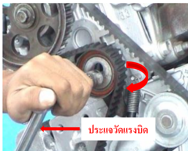
ภาพที่ 3.32 แสดงใช้ประแจวัดแรงบิดขันสลักเกลียวยึดลูกกลิ้งตึงสายพาน ที่มา : ชีระพล บุญธรรม. 2560
