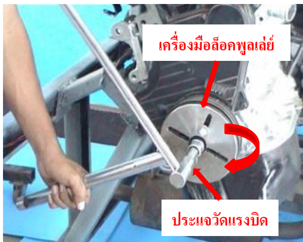
ภาพที่ 3.38 แสดงใช้ประแจวัดแรงบิดขันสลักเกลียวยึดพูลเลย์
