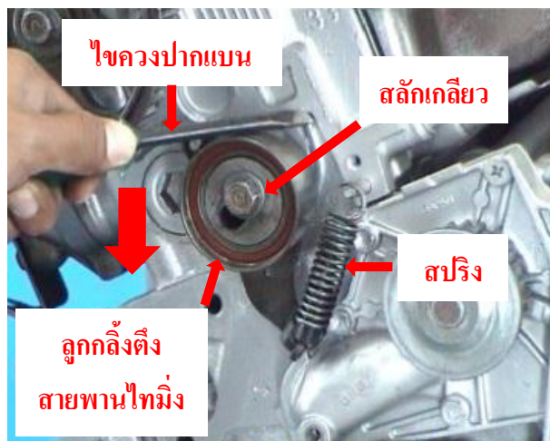
ภาพที่ 3.24 แสดงใช้ไขควงดันให้ลูกกลิ้งตึงสายพาน ที่มา : ชีระพล บุญธรรม. 2560
