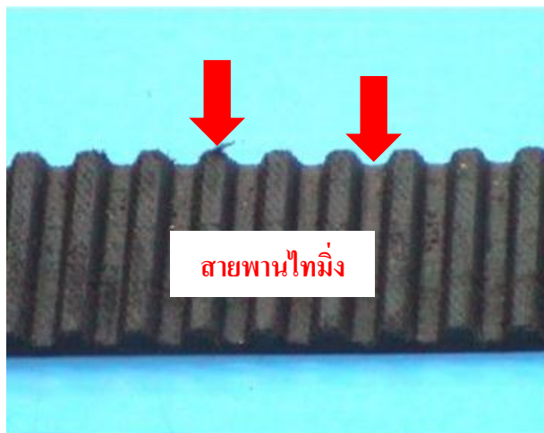
ภาพที่ 3.20 แสดงตรวจสอบความสึกหรอ และแตกร้าวสายพานไทม์มิ่ง ที่มา : ชีระพล บุญธรรม. 2560
