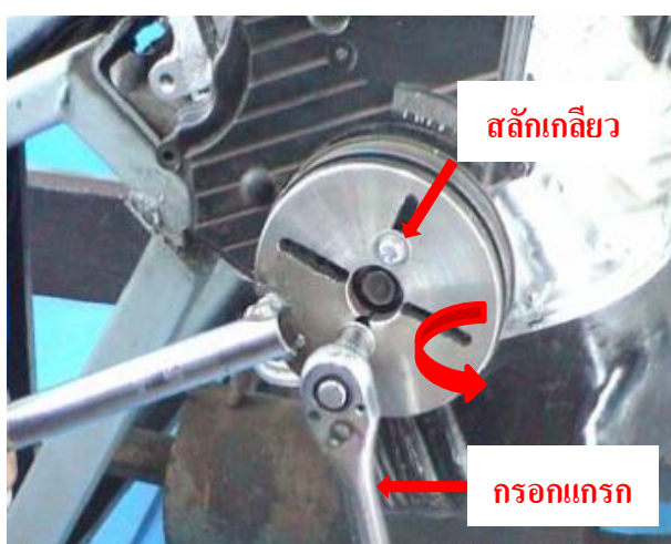
ภาพที่ 3.39 แสดงใช้ด้ามกรอกแกรกถอดสลักเกลียวยึดเครื่องมือถือคพูลเลย์
