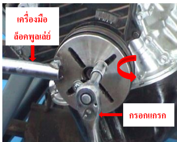
ภาพที่ 3.5 แสดงถอดเครื่องมือล๊อคพูลเลย์เพลลาข้อเหวี่ยงออก
