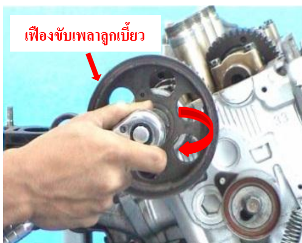
ภาพที่ 3.27 แสดงใช้ประแจหมุนสลักเกลียวยึดเฟืองขับเพลาลูกเบี้ยวให้มาร์คตรง ที่มา : ชีระพล บุญธรรม. 2560
