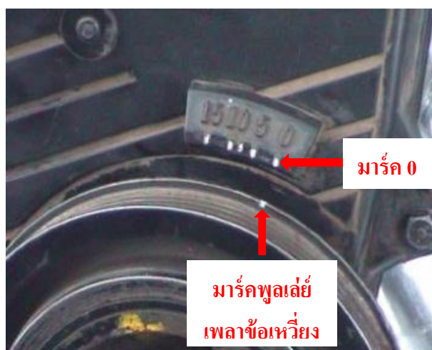
ภาพที่ 3.9 แสดงการตรวจตำแหน่งมาร์คของพูลเลย์ว่าตรงกับมาร์ค 0 ที่ฝาครอบหน้าเครื่อง ที่มา : ชีระพล บุญธรรม. 2560
