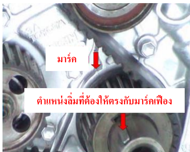
ภาพที่ 3.14 แสดงตำแหน่งลิ้มต้องตรงกับมาร์คเฟืองไทมิ่ง ที่มา : ชีระพล บุญธรรม. 2560
