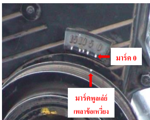
ภาพที่ 3.1 แสดงหมุนเครื่องให้สับที่ 1 อยู่ในตำแหน่งจังหวะอัดและตำแหน่งศูนย์ตายบน ที่มา : ชีระพล บุญธรรม. 2560
