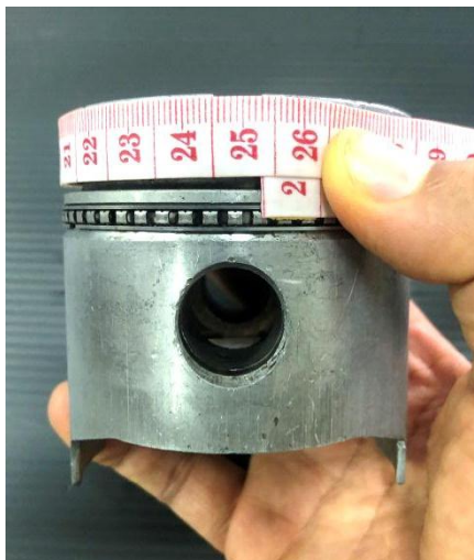
ภาพที่ 1.21 การใช้สายวัดวัดชิ้นงานโดยใช้เส้นอ้างอิง ที่มา : ชีระพล บุญธรรม. 2563
