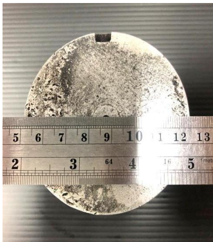
ภาพที่ 1.14 การใช้บรรทัดเหล็กวัดชิ้นงานโดยใช้เส้นอ้างอิง
