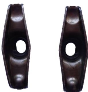
รูปที่ 5.8 กระดิ่งกดลิ้นเครื่องยนต์เล็กแก๊สโซลีน (ที่มา: เสกสรรค์ ไม้เศร้า, 2558)
