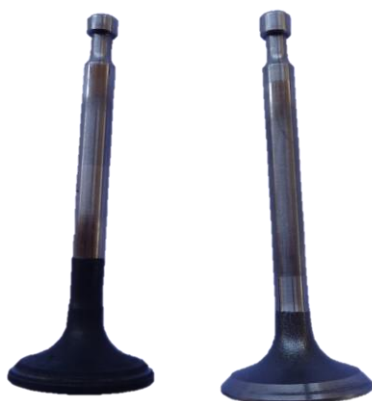
รูปที่ 5.4 ลิ้นเครื่องยนต์เล็กแก๊สโซลีน (ที่มา: เสกสรรค์ ไม่นะร่า, 2558)
