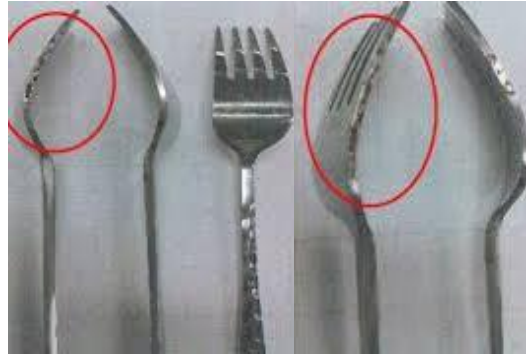
ภาพที่ 11 การเกิดสนิมที่ซ้อนดักอาหาร
