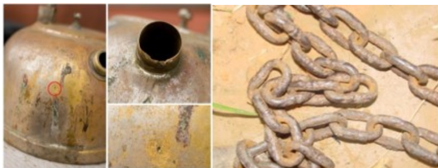
ภาพที่ 8.6 ตัวอย่างการผุกร่อนของโลหะ
