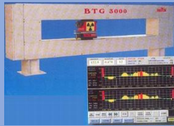
(ข) การใช้รังสีแกมมาวัดระดับของไหลของสารเคมี
