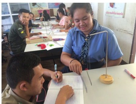
รูป การนำปลายแผ่นเปอร์สเปกซ์ที่ถูด้วยผ้าสักหลาดเข้าใกล้ปลายแผ่นเปอร์สเปกซ์ที่มีประจุซึ่งแขวนอยู่
