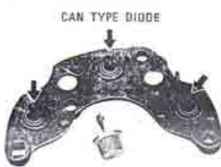
รูปที่ 2.9 แสดงการติดตั้งไดโอดในรถยนต์
