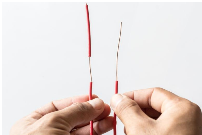
รูปที่ 21 การตัดสายไฟฟ้าชนิด THW (ที่มา นายอภิชาติ ทดราช : 2 มีนาคม 2562)
