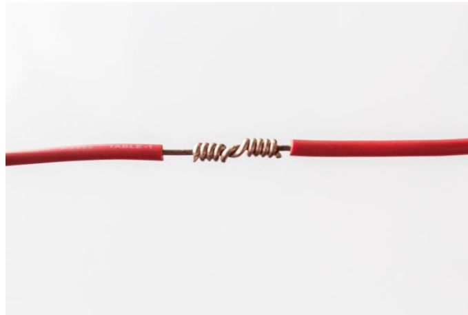
รูปที่ 14 การต่อสายไฟแบบรับแรงดึง (ที่มา นายอภิชาติ ทดราช 2 มีนาคม 2562)
