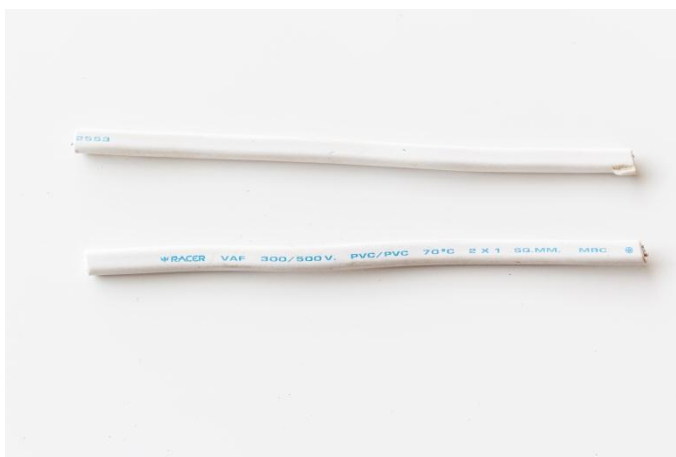
รูปที่ 35 การตัดสายไฟฟ้าชนิด VAF (ที่มา นายอภิชาติ ทดราข : 2 มีนาคม 2562)
