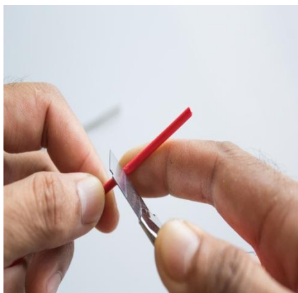
รูปที่ 44 การปลอกฉนวนสายไฟ (ที่มา นายอภิชาติ ทดราช : 2 มีนาคม 2562)
