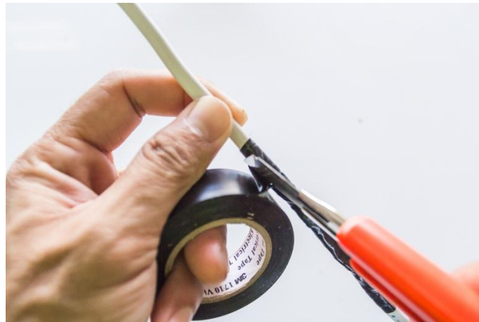
รูปที่ 50 การตัดสายเทปพันสายไฟ (ที่มา นายอภิชาติ ทตราช : 2 มีนาคม 2562)
