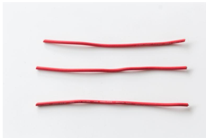
รูปที่ 26 การตัดสายไฟฟ้าชนิด THW (ที่มา นายอภิชาติ ทดราช : 2 มีนาคม 2562)
