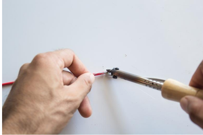
รูปที่ 46 การบัดกรีสายไฟ (ที่มา นายอภิชาติ ทดราช : 2 มีนาคม 256)
