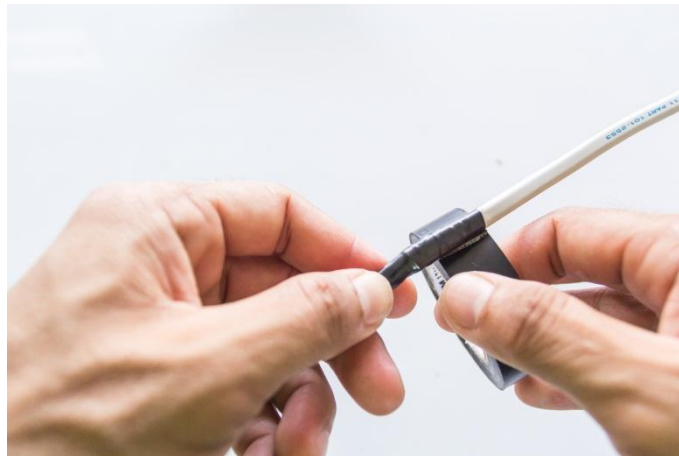
รูปที่ 49 การพันสายไฟ (ที่มา นายอภิชาติ ทดราช : 2 มีนาคม 2562)
