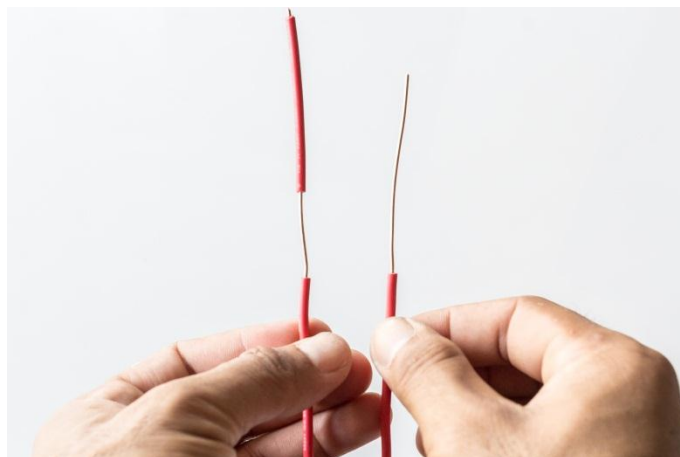
รูปที่ 16 การตัดสายไฟฟ้าชนิด THW (ที่มา นายอภิชาติ ทดราช : 2 มีนาคม 2562)
