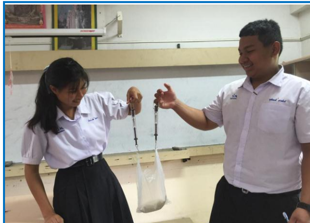
ภาพที่ 1.2 : วิธีการทดลองใช้เครื่องชั่งสปริงสองอันวัดขนาดของแรง
