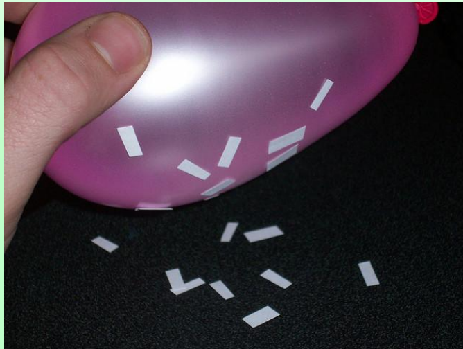
ภาพ 1.3 กระดาษลอยไปติดลูกโป่งด้วยแรงไฟฟ้าสถิต
