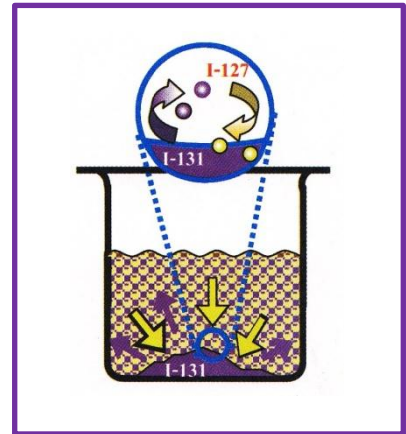
ภาพที่ 9 แสดงสารละลายอิ่มตัวของไอโอดีน ในเอทานอลซึ่งเติมเกล็ดไอโอดีนกัมมันตรังสีลงไป
