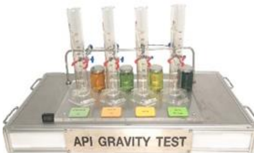
ภาพที่ 1.1 ชุดทดลองการหาค่าความถ่วง เอ พี ไอ ที่มา : ไพศาล พรณฤชิตพงศ์ (2565)
