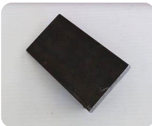
ภาพที่ 21 ผลงานที่ได้จากการตัดเหล็กด้วยเลื่อยมือ
