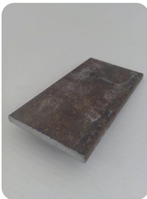
ภาพที่ 29 ชิ้นงานสำเร็จจากการตัดด้วยเครื่องตัดไฟฟ้า
