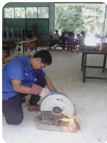
ภาพที่ 27 ตัดชิ้นงานลงเบาๆอย่างมั่นคง
