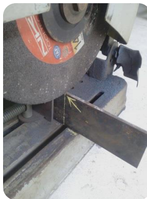
ภาพที่ 26 ปรับระยะขึ้นงานให้ใบตัดตรงรอยขีดพอดี
