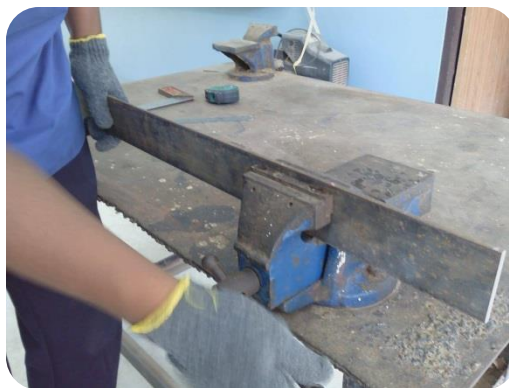
ภาพที่ 18 การจับยึดชิ้นงานบนปากกาหัวโต๊ะ
