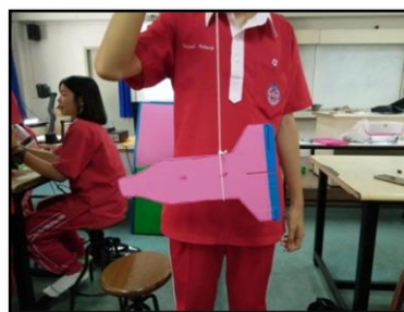
ภาพ 17 การหาจุดศูนย์กลางแรงดัน (Center of Pressure) CP
