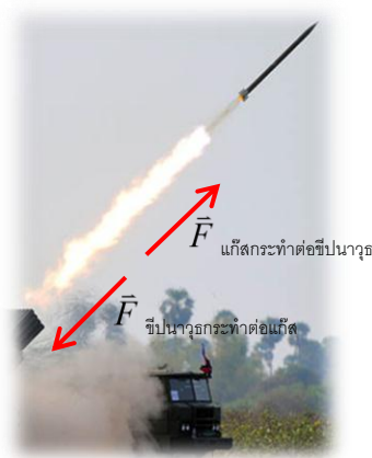
รูป 4 แรงสำหรับการเคลื่อนที่ของซีปนาวุธ (ฟิสิกส์ราชมงคล, 2554)
