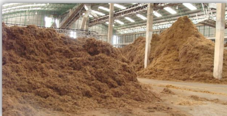
ภาพที่ 12 เส้นใยทางใบปาล์มและทะลายเปล่า เป็นเชื้อเพลิงผลิตกระแสไฟฟ้า
