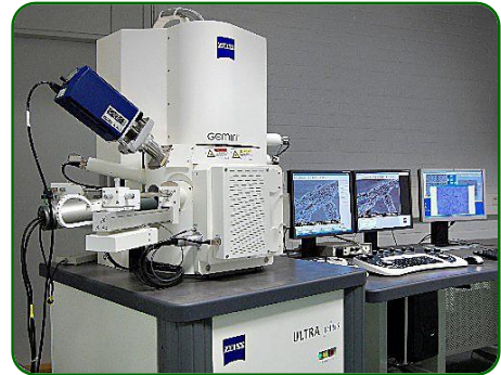
ภาพที่ 1.36 กล้องจุลทรรศน์อิเล็กตรอนแบบส่องกราด ที่มาภาพ 1.36:
