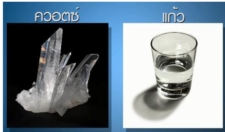
ภาพที่ 2.23 แสดงผลึกของควอตซ์และแก้วที่เป็นของแข็งออสัญฐาน ที่มา : นงนุช เหมือนสิน, 2554 : 44
