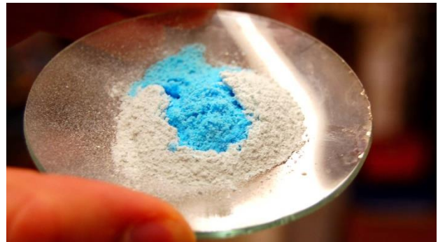
ภาพที่ 9 การทดสอบน้ำโดยใช้จุนสีสะตุ ที่มา : https://goo.gl/18i139
