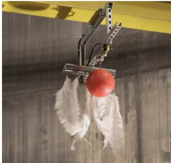
ภาพที่ 7 การตกของลูกบอลกับขนนก ภายในห้องที่สุญญากาศออกหมด
