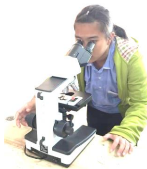
ภาพที่ 1.15 วางสไลด์ที่แท่นวางวัตถุ ใช้เลนส์ใกล้วัตถุ 10x
