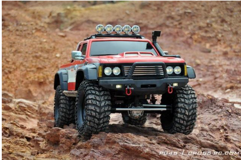
รูปที่ 1.5 แสดงลักษณะยางรถยนต์ที่มีลวดลายเพื่อเพิ่มแรงเสียดทาน
