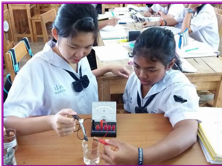
ภาพที่ 1.13 ยกแผ่นสังกะสีออกจากสารละลายกรดซัลฟิวริก
