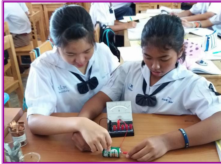
ภาพที่ 1.9 ต่อเครื่องวัดกระแสไฟฟ้าอย่างง่ายเข้ากับถ่านไฟฉาย
