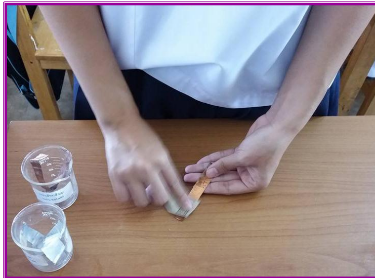
ภาพที่ 1.10 ขัดแผ่นทองแดงและแผ่นสังกะสี
