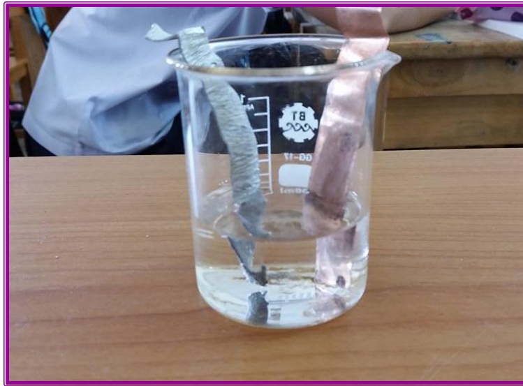
ภาพที่ 1.11 จุ่มแผ่นทองแดงและแผ่นสังกะสีลงในสารละลายกรดซัลฟิวริก
