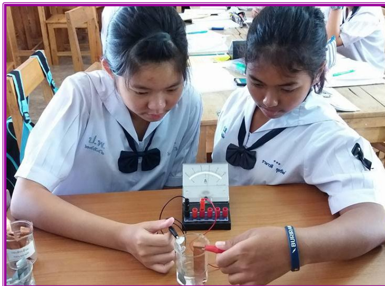
ภาพที่ 1.12 ต่อเครื่องวัดกระแสไฟฟ้าอย่างง่ายเข้ากับแผ่นทองแดงและแผ่นสังกะสี
