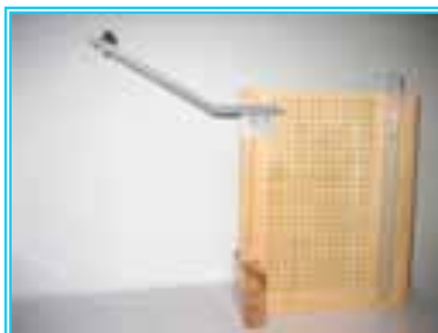
ภาพที่ 1.2 การจัดอุปกรณ์ศึกษาแนวการเคลื่อนที่ของการเคลื่อนที่แบบโพรเจกไทล์
