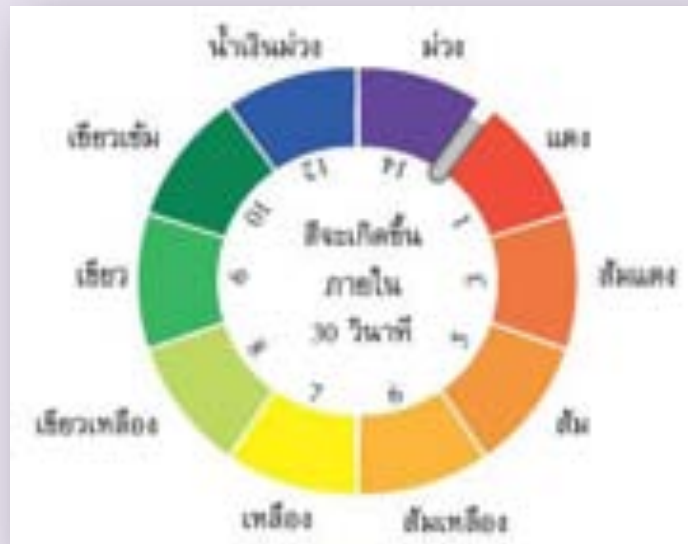
ภาพที่ 3.7 การเปลี่ยนสีของกระดาษยูนิเวอร์ซัลอินดิเคเตอร์
