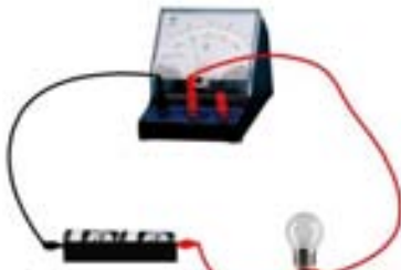
ภาพที่ 1.8 การต่อแอมมิเตอร์ เข้ากับวงจร
