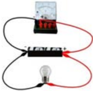
ภาพที่ 1.2 การต่อโวลต์มิเตอร์ เข้ากับวงจร
