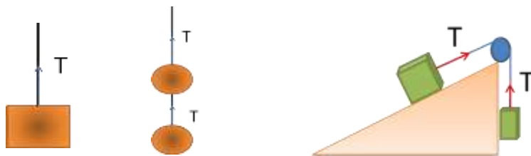
รูป 4 แรงที่กระทำต่อวัตถุที่แขวนด้วยเชือกเกิดแรงดึงในเส้นเชือก
