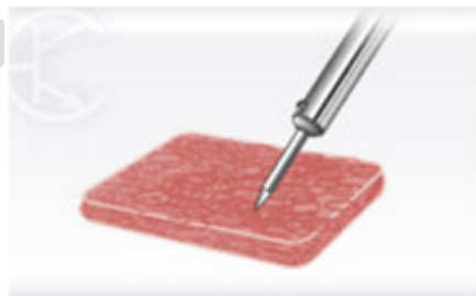
รูปที่ 3.19 การทำความสะอาดปลายหัวแร้งแช่
