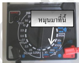
(ก) รูปแสดงการตั้งมัลติมิเตอร์เพื่อวัดกระแสไฟฟ้า (ข) รูปแสดงสายวัดของมัลติมิเตอร์
