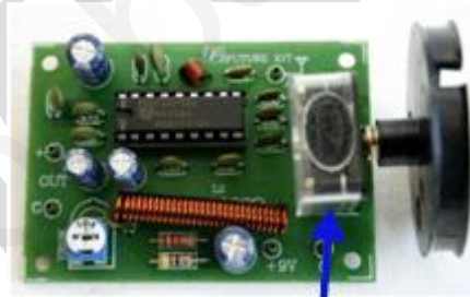
รูปที่ 2.19 ตัวเก็บประจุชนิดเปลี่ยนค่าได้ในเครื่องรับวิทยุ
