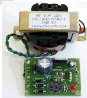
รูปที่ 2.25 วงจรแปลงไฟฟ้ากระแสสลับเป็นไฟฟ้ากระแสตรง (Rectifier)
