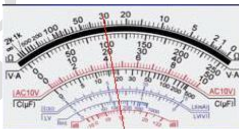
รูปแสดงเข็มวัดชี้ตำแหน่งค่าความต่างศักย์ไฟฟ้าที่วัดได้
