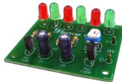
รูปที่ 2.41 วงจรไฟกระพริบ ควบคุมด้วยทรานซิสเตอร์
