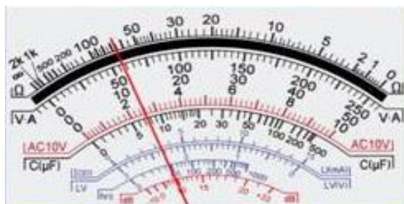
รูปแสดงเข็มวัดชี้ตำแหน่งค่ากระแสไฟฟ้าที่วัดได้
