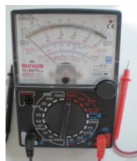
(ก) รูปแสดงการตั้งมัลติมิเตอร์เพื่อวัดกระแสไฟฟ้า (ข) รูปแสดงสายวัดของมัลติมิเตอร์
