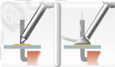
รูปที่ 3.21 ป้อนความร้อนและตะกั่วบัดกรีให้กับชิ้นงาน
