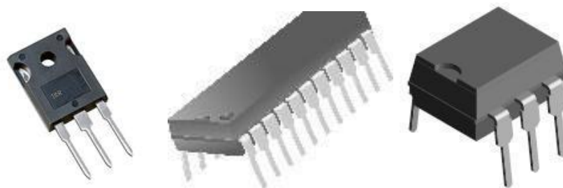
รูปที่ 2.43 ตัวอย่างวงจรรวม (IC) แบบต่างๆ
