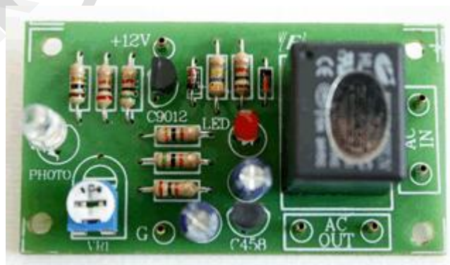
รูปที่ 2.7 ตัวต้านทานค่าคงที่ ในวงจรสวิทช์ทำงานด้วยแสง
