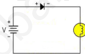
รูปที่ 2.22 การไบแอสตรง (Forward Bias)
